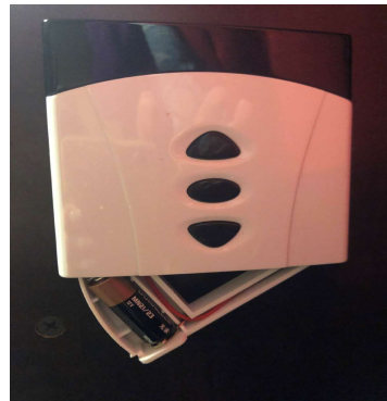
Un interruptor de pared inalámbrico(remoto) Mostrando el acceso a la batería
