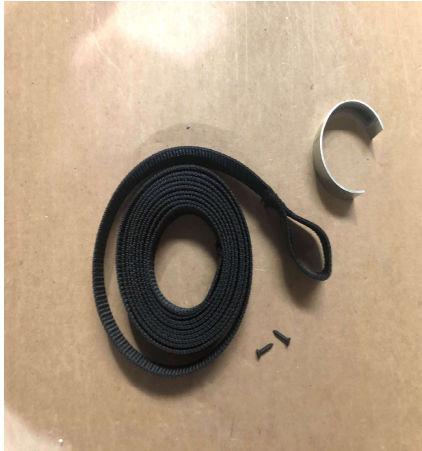
Correa con herrajes, pinza metalica y dos pequeños tornillos de anclaje
